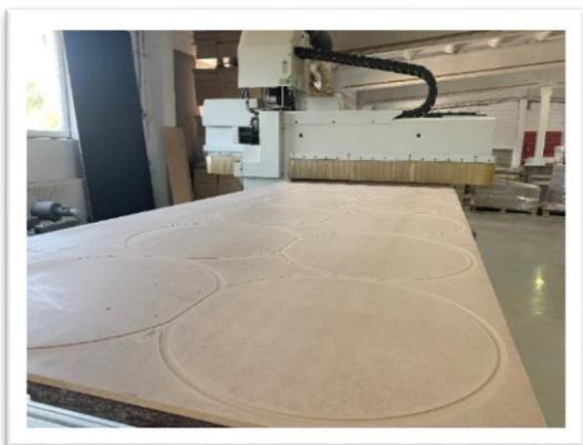
Автоматический комплекс для резки МДФ
